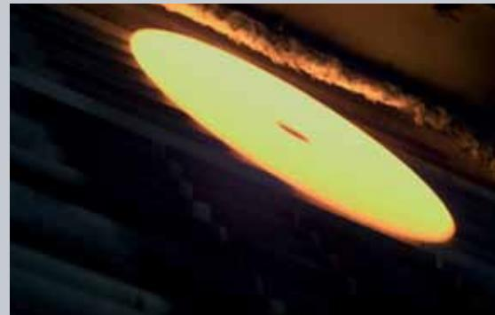
IL DISCO GREZZO VIENE PRELEVATO IN AUTOMATICO PORTATO PROGRESSIVAMENTE AD UNA TEMPERATURA DI 1200°C E RAFFREDDATO RAPIDAMENTE A 60°C SOTTO PRESSA A CHIUSURA TEMPORIZZATA E INFINE SCARICATO AUTOMATICAMENTE AL MAGAZZINO DEL TRATTATO.
